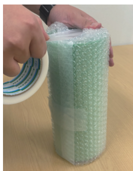
緩衝材の固定
